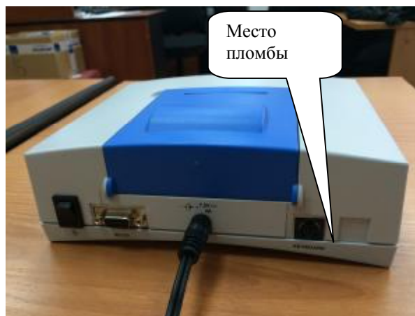
Рис. 2 - Экспресс-анализатор Easy Reader. Место пломбы.
